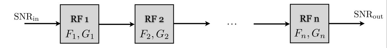
$$F = F_1 + \frac{F_2 - 1}{G_1} + \frac{F_3 - 1}{G_1 G_2} + \frac{F_4 - 1}{G_1 G_2 G_3} + \dots + \frac{F_n - 1}{G_1 G_2 G_3 \cdots G_{n-1}}$$
