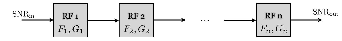
$$F = F_1 + \frac{F_2 - 1}{G_1} + \frac{F_3 - 1}{G_1 G_2} + \frac{F_4 - 1}{G_1 G_2 G_3} + \dots + \frac{F_n - 1}{G_1 G_2 G_3 \dots G_{n-1}}$$
